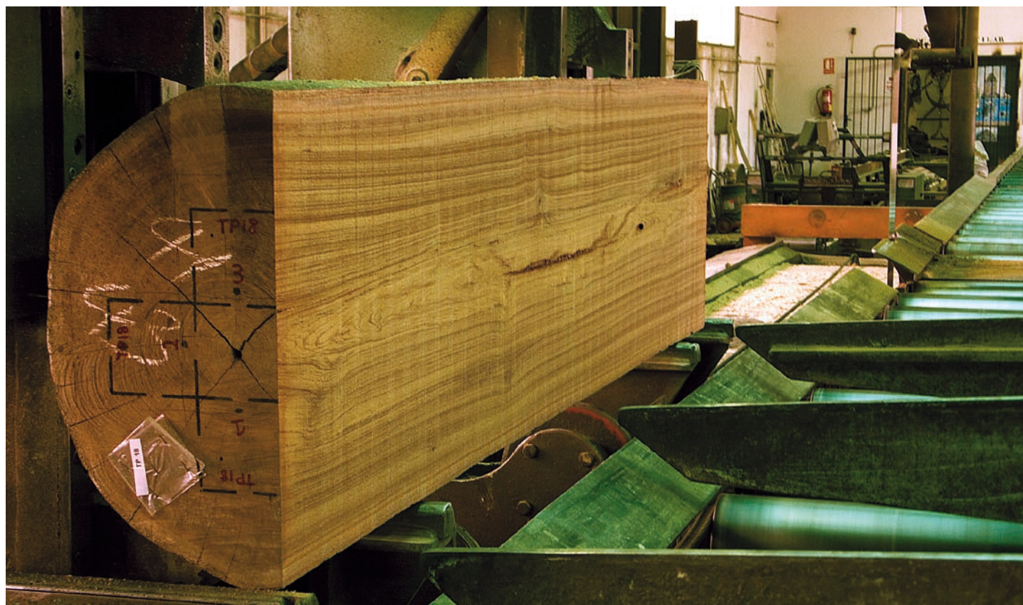
Aplicación de los conceptos de alineado de Palacios sobre un tronco de teca. Fotografía tomada por Luis Magán
